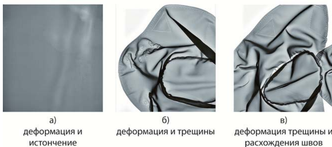
Рисунок 3.1.3. - рентгеновский снимок повреждения фартука (а) и шапочки (б,в)
