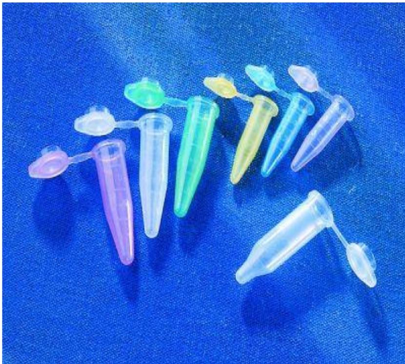
Рис. 5. Пробирки типа «Eppendorf».
