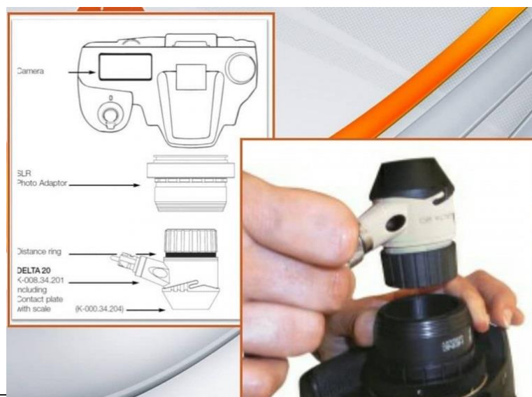
Рисунок 2.2. Схематическое изображение подключения дерматоскопа к фотоаппарату при помощи адаптеров
