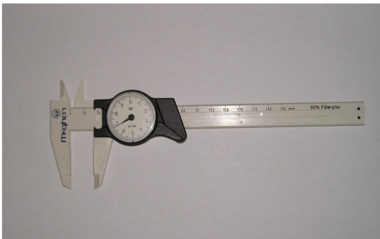
Рисунок 2.9 – Медицинский штангенциркуль фирмы McGhan с ценой деления 0,1 мм
